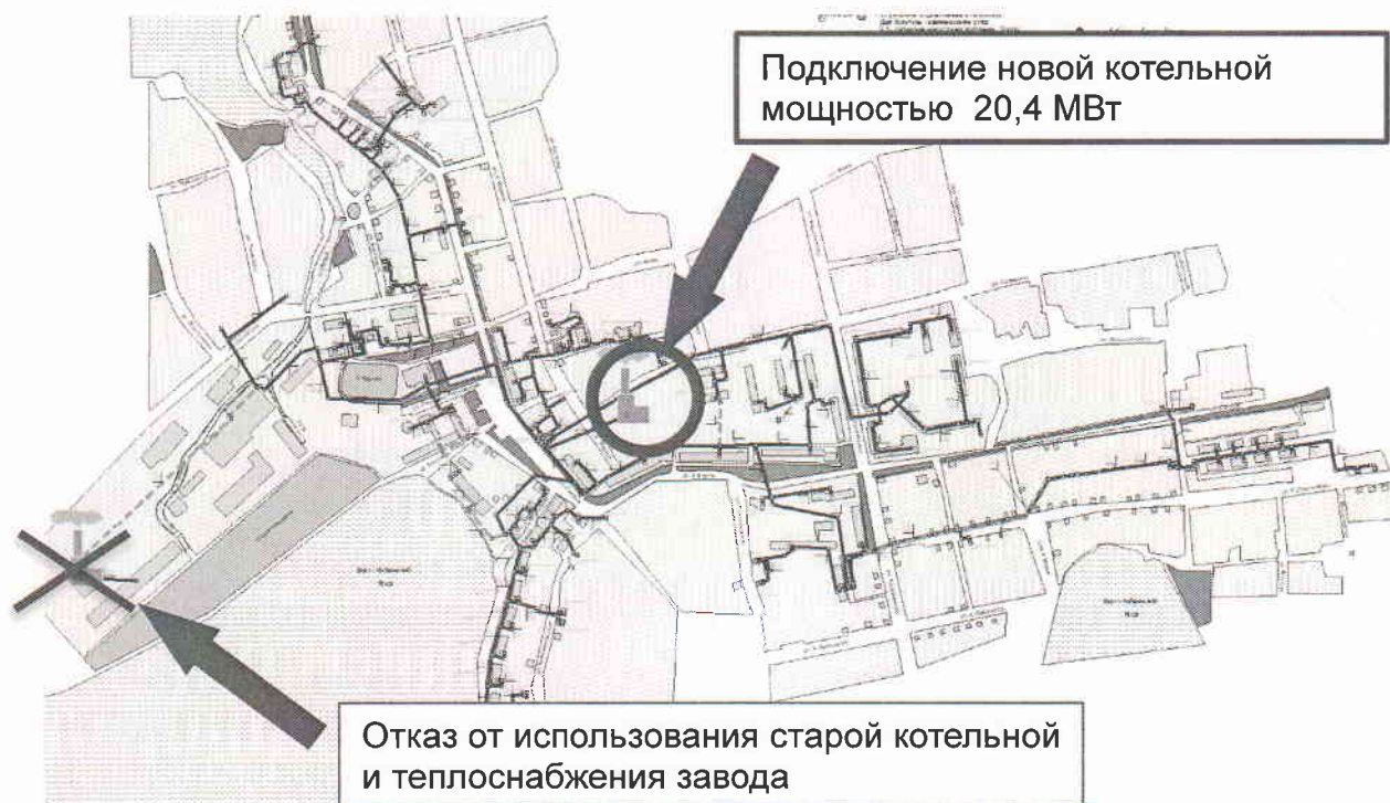
Рис. 2. Схема тепловой сети с перспективными зонами действия систем теплоснабжения и источников тепловой энергии
